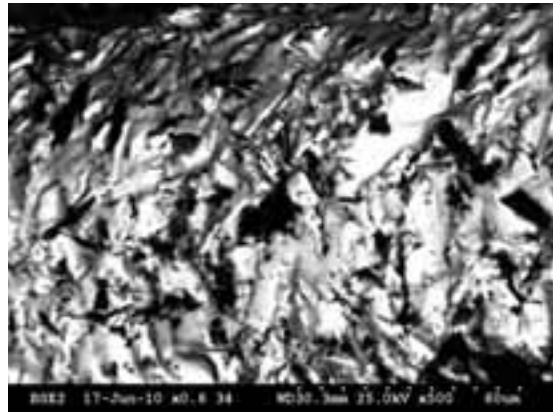
Fig. 30 3M Espe MDI MAX implant, BSE x500.
